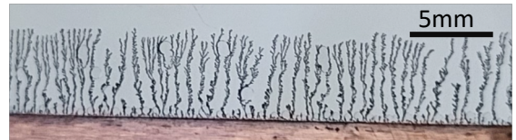
Figure 1 : dendrites formées sur la cathode lors d'un séquence d'électrodéposition
