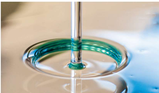
Figure : ressaut circulaire hydraulique d'huile silicone.
